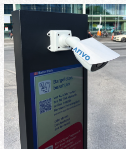
LPR-Kamera und Display mit Hilfestellung für die Bezahlung der Parkgebühr
